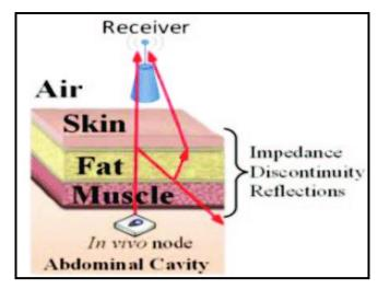
Fig. 3: In vivo multi-path channel.<sup>[3]</sup>
