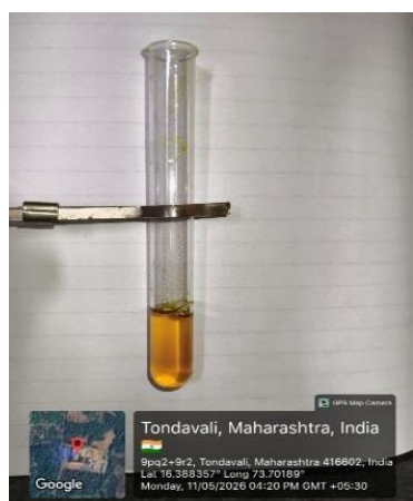
Fig. No. 5.1 Fehlings test.
