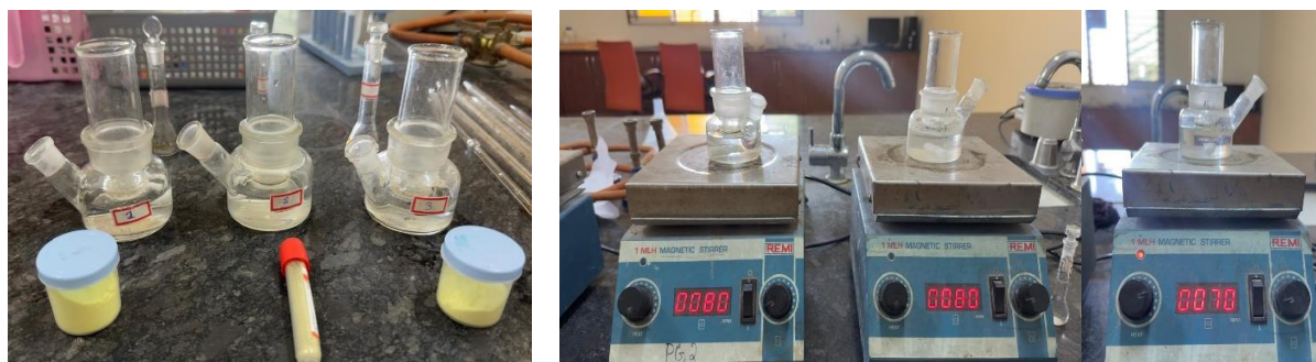
Fig. 6: Franz Diffusion Apparatus – permeation study of DYSG, CBG, GSG.
